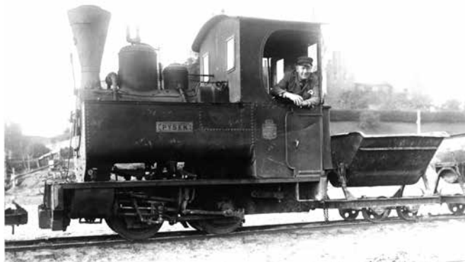
Det lilla 600 mm-ångloket PYSEN (Decauville 60/1889) från Kosta-Lessebo Järnväg hamnade år 1932 som entreprenadlok i Kalmar då Slottsfjärden skulle muddras. Sedan arbetena avslutats ställdes loket i förråd, men då ångpannan var i dåligt skick kom det att skrotas knappa 20 år senare. Samling: Järnvägsmuseet (okänd fotograf)
