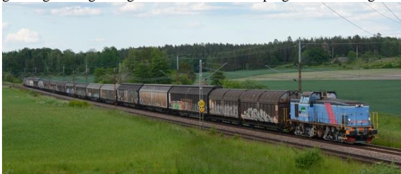
Godståg Norrköping – Kimstad – Finspång dragen av dieseldrivet T44. Även ett diesellok längst bak då tåget byter riktning vid Kimstad.
